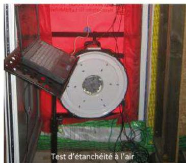
Test d'étanchéité à l'air
