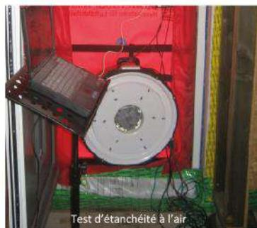
Test d'étanchéité à l'air
